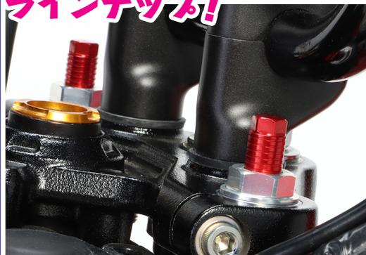
舗装道、砂利道、林道とあらゆる状況に応じた足周りのセッティングやリアショック交換後のフロントフォークのセッティングに!! フロントフォークスプリングのプリロード”抜き””掛け”の調整が可能になるアジャスターです。
