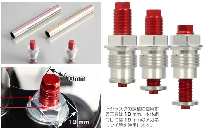
アジャスタの調整に使用する工具は10mm、本体組付けには19mmのメガネレンチ等を使用します。
